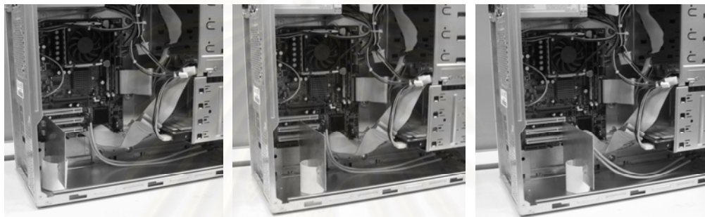
รูปที่ 4.61 การจัดวางชิ้นโลหะภายในกล่องคอมพิวเตอร์ที่ระยะห่าง 5, 10 และ 15 เซนติเมตร
