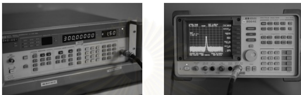
รูปที่ 3.5 การใช้อุปกรณ์ในการวัดตามมาตรฐาน MIL-STD-285
