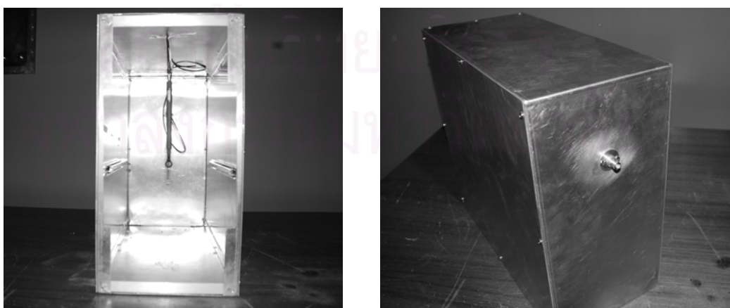
รูปที่ 3.8 แสดงการจัดวางโพรบ (probe) ในกล่องปิดกั้น
