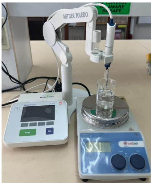
ภาพที่ 3.2 เครื่อง METTLER TOLEDO SevenCompact™ pH/Ion meter S220
