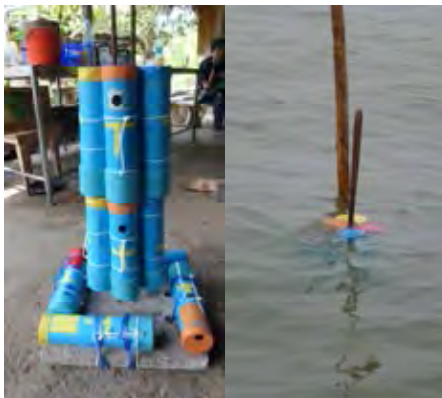
โครงดักตะกอน (ซ้าย) และโครงดักตะกอนหลังจากการติดตั้งในทะเล (ขวา) เพื่อวัดการเคลื่อนตัวของตะกอนแขวนลอยบริเวณแนวไม้ไผ่ป้องกันคลื่นป่าชายเลน ตำบลแหลมใหญ่ จังหวัดสมุทรสงคราม
