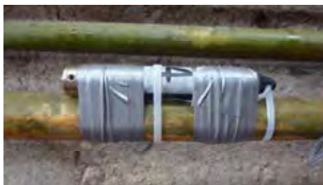
การติดตั้งเครื่องวัดคลื่นไว้กับไม้ไผ่เพื่อนำไปปักบนเลน
