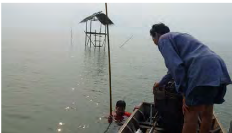
การปักไม้ไผ่ซึ่งติดตั้งเครื่องวัดคลื่นลงบนพื้นตะกอน
