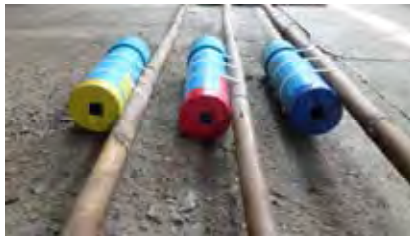
กระบอกพลาสติกแนวตั้งเจาะรูด้านบนสำหรับการสะสมตัวของตะกอนท้องน้ำ
