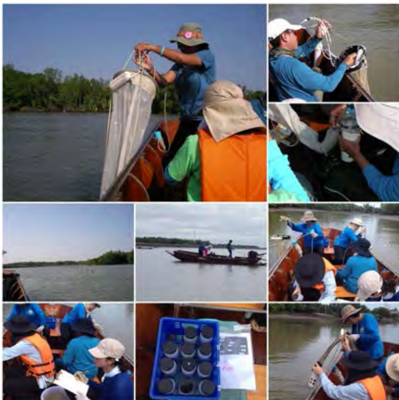
การศึกษาปัจจัยสิ่งแวดล้อมในน้ำและการเก็บตัวอย่างน้ำเพื่อวิเคราะห์ปริมาณสารอาหารและคลอโรฟิลล์ เอ และการเก็บตัวอย่างแพลงก์ตอนพืชและแพลงก์ตอนสัตว์
