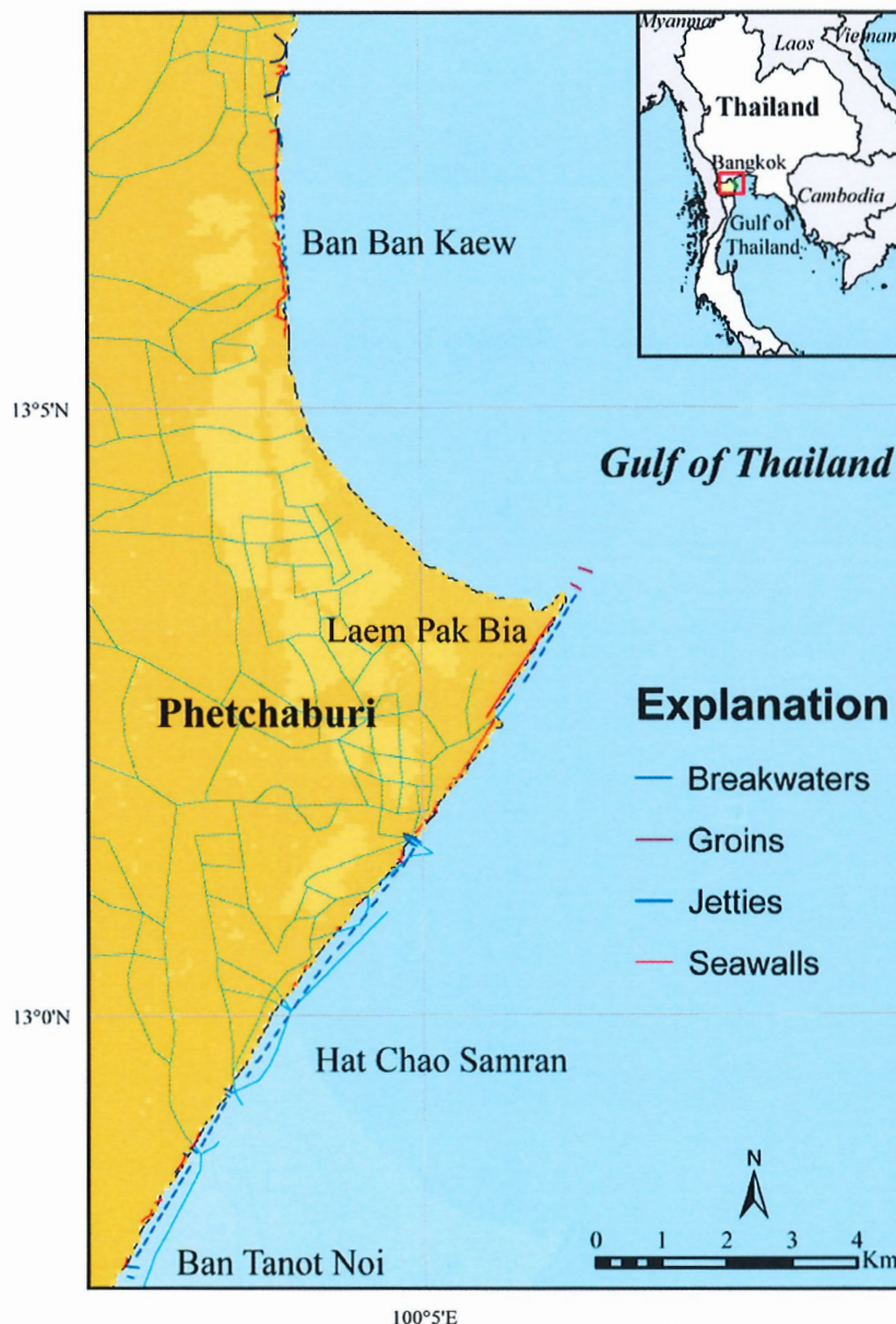
รูป 10 โครงสร้างทางวิศวกรรมตามแนวชายฝั่งเพชรบุรี
