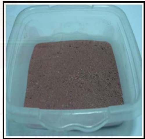
รูปที่ 4.4 ซิลิกา-อะลูมินาที่ใช้แล้วบด ขนาด 100 เมช (0.15 มม.)
