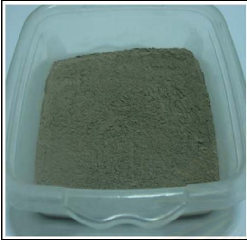
รูปที่ 4.1 ดินดำ (Ball Clay) ขนาด 200 เมช (0.075 มม.)
