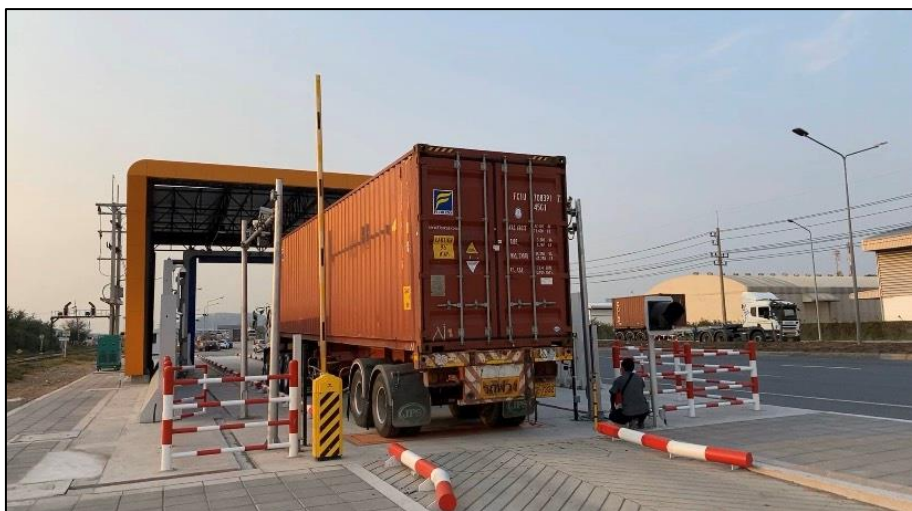
ภาพที่ 7 เครื่องเอกซเรย์แบบขับผ่าน (Drive Through X-ray Container Inspection System) ที่มา: ส่วนเทคโนโลยีการควบคุมทางศุลกากร ศูนย์ประมวลผลข้อมูลการข่าวทางศุลกากร
