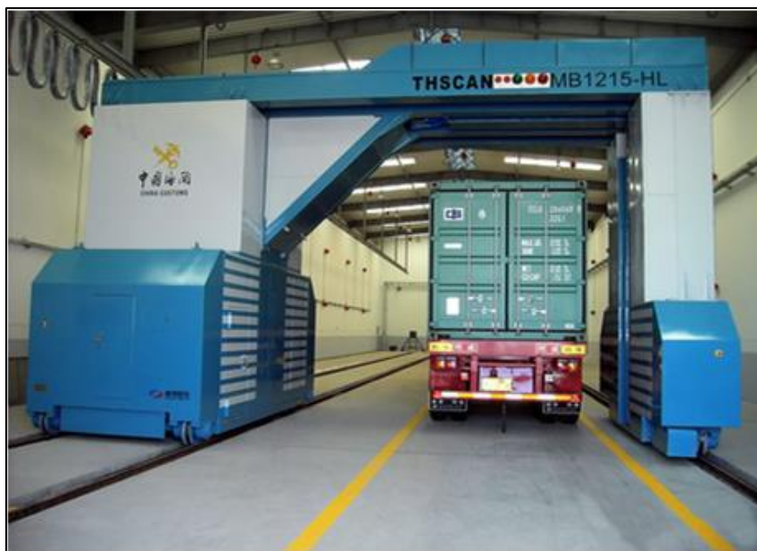
ภาพที่ 6 เครื่องเอกซเรย์แบบถอดประกอบเคลื่อนย้ายได้ (Relocatable) ที่มา: ส่วนเทคโนโลยีการควบคุมทางศุลกากร ศูนย์ประมวลข้อมูลการข่าวทางศุลกากร
