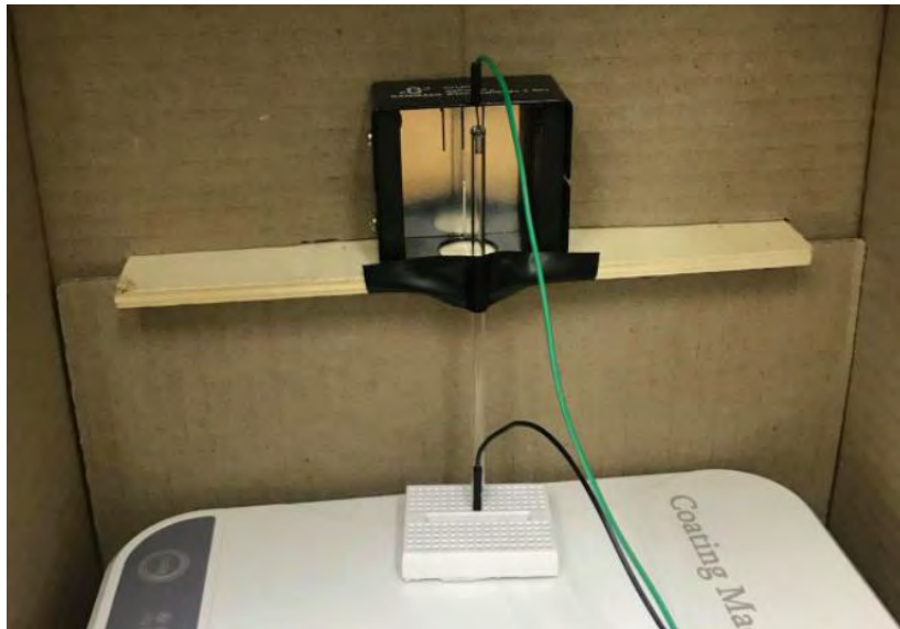
รูปที่ 3.6 แสดงลักษณะการวางหลอดและครอบด้วยกล่องเพื่อป้องกันอันตรายจากรังสีอัลตราไวโอเล็ต
