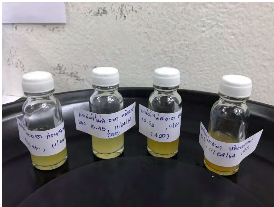
รูปที่ 4.2 แสดงการทดลองการฆ่าเชื้อของหลอดรังสีอัลตราไวโอเล็ตโดยใช้ชุดทดสอบสำหรับการทดสอบโคลิฟอร์มแบคทีเรียขั้นต้น (SI-2)
