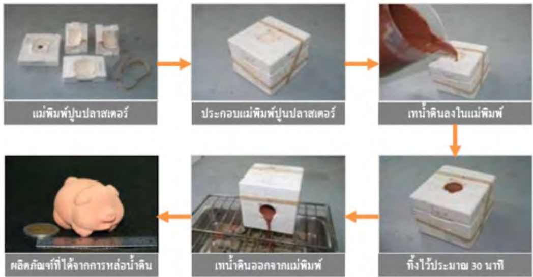
รูปที่ 3.2 แม่พิมพ์ปูนปลาสเตอร์และขั้นตอนการเทแบบ
