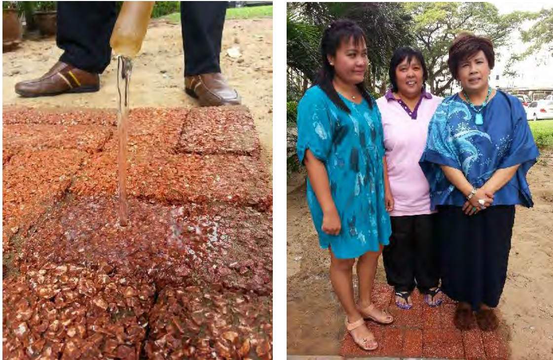
รูปที่ 4.18 แสดงการระบายน้ำของอิฐเซรามิกพูน (ซ้าย) และลักษณะของการใช้งานรองรับน้ำหนักของอิฐเซรามิกพูน (ขวา)
