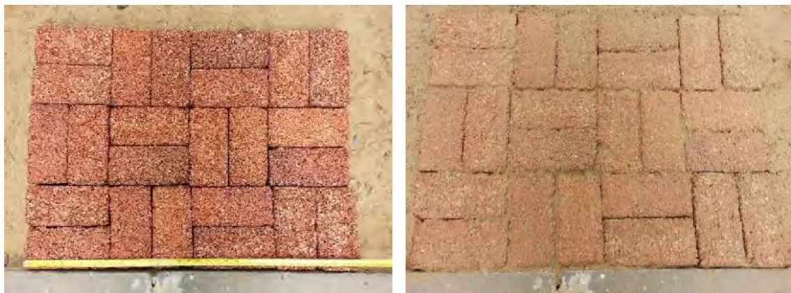
รูปที่ 4.17 แสดงการจัดเรียงอิฐเซรามิกพรุนบนพื้นสนาม (ซ้าย) และลักษณะของอิฐเซรามิกพรุนหลังการใช้งาน (ขวา)
