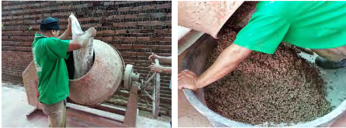
รูปที่ 4.15 แสดงกระบวนการผสมวัตถุดิบ (ซ้าย) และลักษณะของเนื้ออิฐพูนที่ได้จากการผสม (ขวา)
