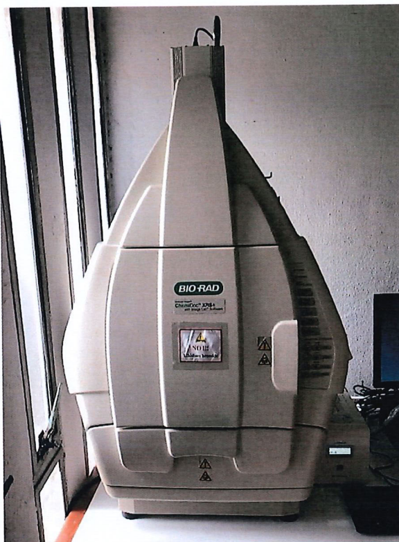
รูปที่ 13 เครื่องถ่ายภาพ ChemiDoc™ XRS+ (BIO-RAD)
