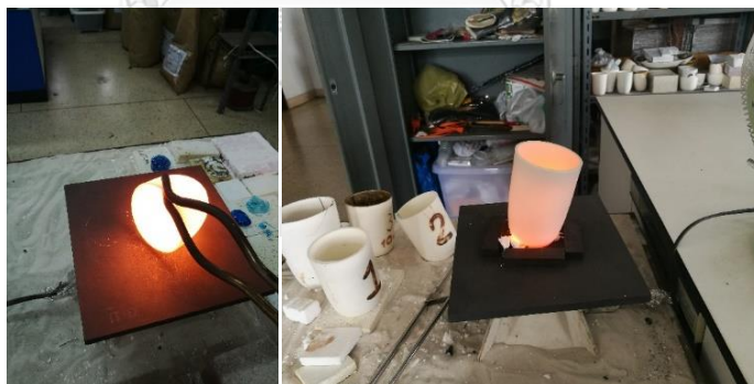
ภาพที่ 7 แสดงเบ้าหลอมอะลูมินาที่นำออกจากเตาเพื่อลดอุณหภูมิ
