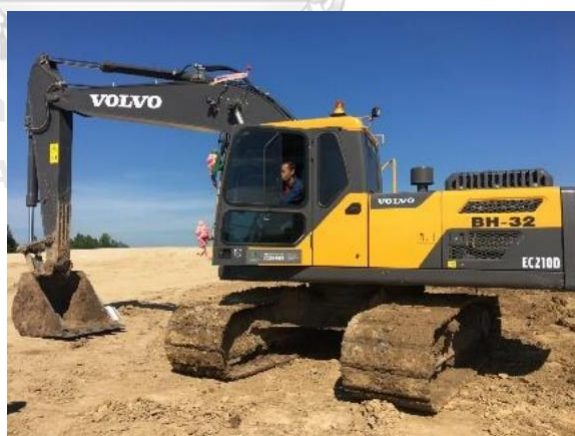
ภาพที่ 2.4 ตัวอย่างรถขุดไฮดรอลิกแบบเข้าหาตัวรถชนิดตีนตะขาบ
