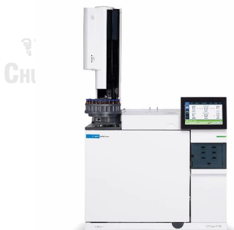
รูปที่ 3.9 Gas Chromatography-Flame Ionization Detector; GC-FID) Agilent Model 8890 with Auto-sampler
