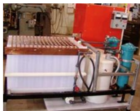
ภาพที่ 2.6 การแยกสกัดโลหะด้วยเทคโนโลยีโลหะวิทยาไฟฟ้าเคมี [8]
