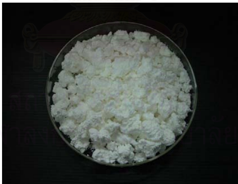
รูปที่ 4.1 ลักษณะทางกายภาพของเมทาคริลิก-มาเลอิกแอนไฮไดรด์โคพอลิเมอร์
