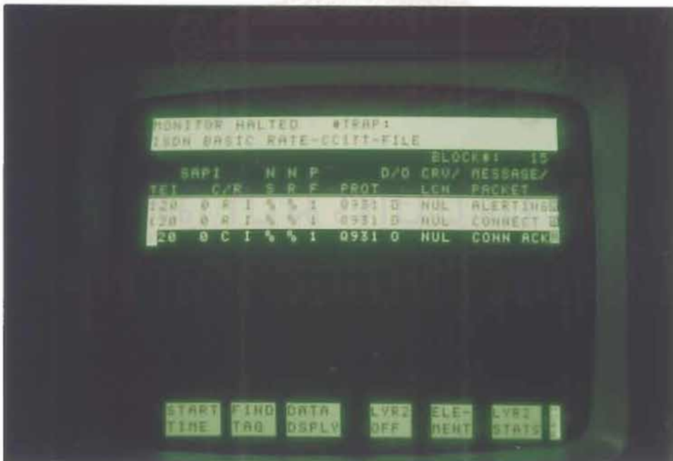
รูป 2.11 การขอเริ่มเชื่อมต่อในช่องสัญญาณ B
