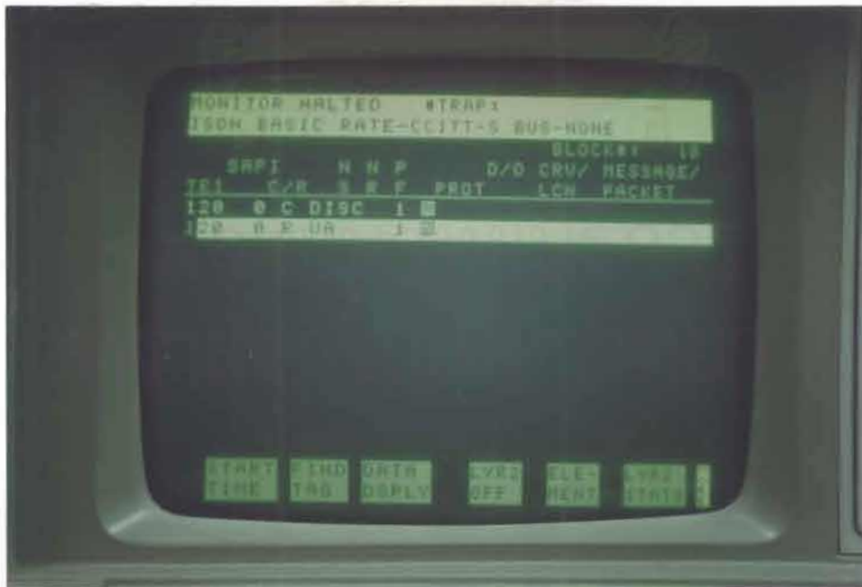
รูปที่ 2.10 การขอสิ้นสุดการเชื่อมต่อในช่องสัญญาณ D ของโทรศัพท์ ISDN
