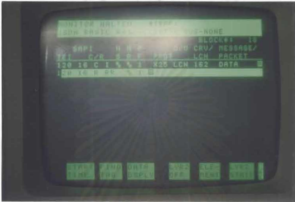
รูปที่ 2.9 การส่งข้อมูลในช่องสัญญาณ D ของโทรศัพท์ ISDN
