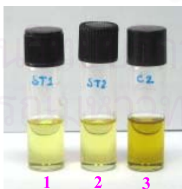
รูปที่ 3.1 น้ำมันจากเมล็ดแมงลักที่สกัดจากตัวทำละลายและวิธีทางกายภาพร่วมกับตัวทำละลาย โดย
