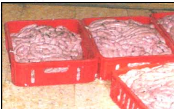
ภาพที่ 1.7 การวางผลิตภัณฑ์ระหว่างผลิตไม่เหมาะสม
