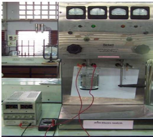
รูปที่ 3.4 การแยกไอออนทองแดงออกจากสารละลายกรดไฮโดรคลอริกด้วย เครื่องแยกไอออนทองแดง (Electro Analysis)
