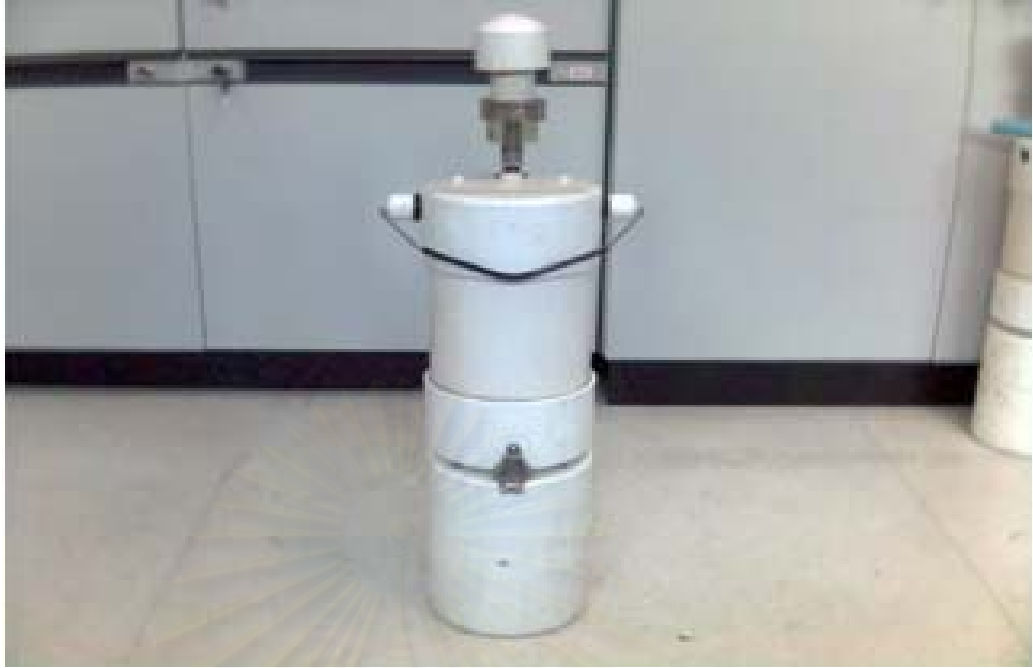
รูปที่ 3.7 เครื่องเก็บตัวอย่างฝุ่นละอองขนาดเล็กไม่เกิน 10 ไมครอน ชนิด Mini Volume Air Sampler
