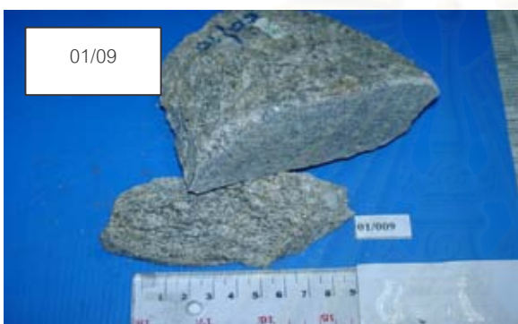
หินแกรนิตที่มีแร่มีสโคไวท์และไบโอไทต์ เนื้อหินแสดงลักษณะเนื้อดอกและมีรูปร่างที่ชัดเจนคือแร่อัลคาไลเฟลสปาร์ ขนาดผลึกมีตั้งแต่เล็กไปจนถึงใหญ่ และจากผลวิเคราะห์ทางด้านเคมีถูกจัดให้อยู่ในกลุ่มที่ 5 (Allanite+tourmaline+biotite+muscovite porphyry granite) พบที่ Grid reference 063 707 บริเวณ บ้านแหลมแท่น
