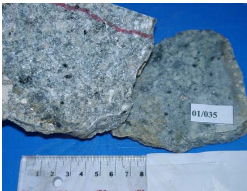
รูป 4.11 ตัวอย่างหินไบโอไทต์-มัสโคไวท์แกรนิต แสดงผลึกขนาดปานกลางถึงหยาบ แสดงลักษณะเนื้อดอกพบที่ Grid reference 266 560 บริเวณ วัดบ้านโค้งตาสา
