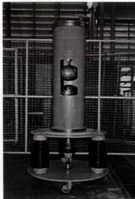
รูปที่ 2.4 Crowbar spark gap ติดตั้งภายในห้องความดันที่วิชีอัดความดันก๊าซ (มีการตัดต่อภาพให้เห็นภายใน)
