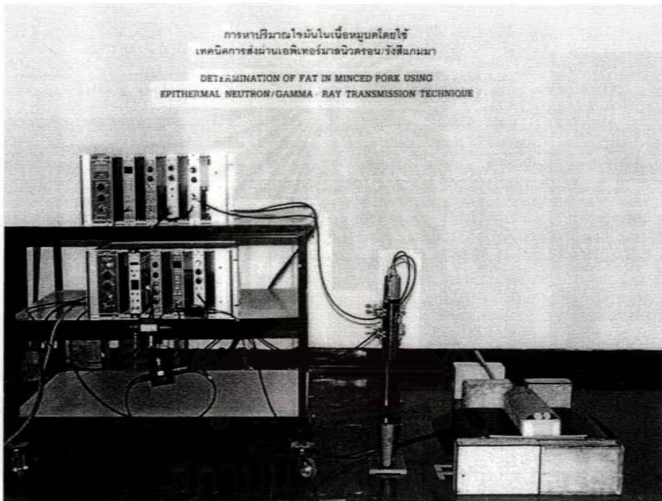
รูปที่ 4.7 แสดงการจัดระบบวัดรังสีโดยเทคนิคการส่งผ่านเอพิเทอร์มัลนิวตรอนและรังสีแกมมา
