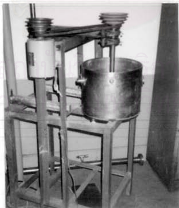
รูปที่ 3.2 แสดงชุดเครื่องกวนอัตราเร็วสูง
