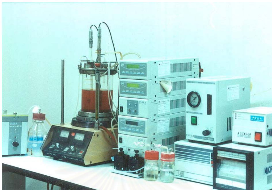
รูปที่ 10 การผลิตกรดโคจิกในถังหมักขนาด 2 ลิตร โดยมีการใช้เครื่องควบคุมและตรวจวัดค่าความเป็นกรดต่าง ค่าออกซิเจนละลายและระดับฟอง
