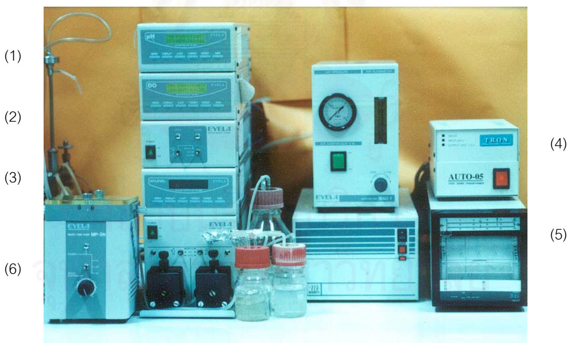
รูปที่ 11 เครื่องควบคุมและตรวจวัด ค่าความเป็นกรดต่าง (1) ค่าออกซิเจนละลาย (2) ระดับฟอง (3) ป้อนอากาศ (4) เครื่องบันทึกผลการทดลอง (5) และ ป้อนเติมสาร(6)
