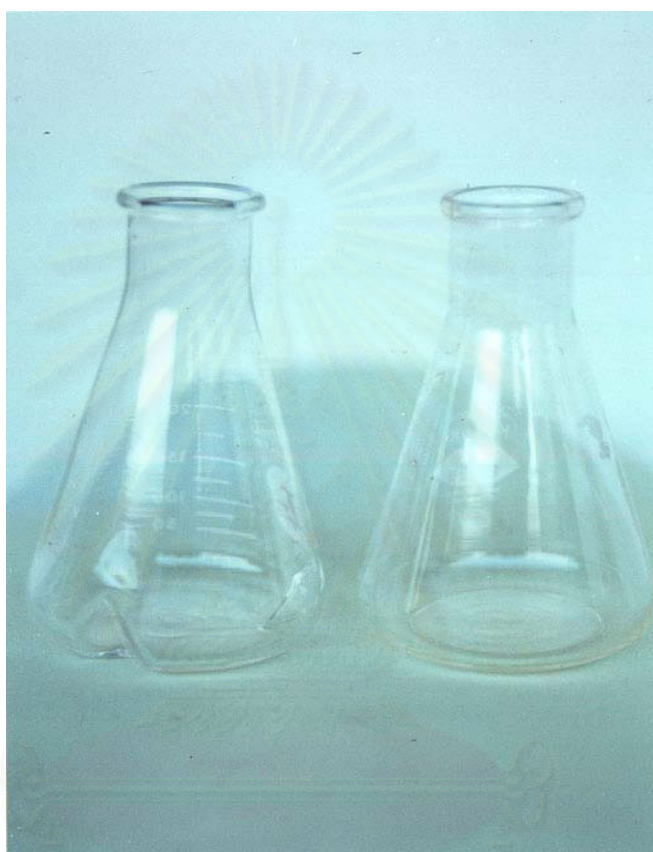
รูปที่ 12 ลักษณะของขวดเขย่าปกติ และ ขวดเขย่าก้านบุบ
