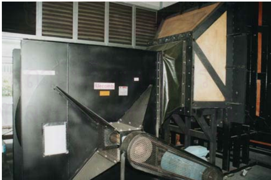
รูปที่ 2.2 พัดลมหอยโข่ง (Centrifugal Blower) ชนิดใบพัดแบบ Backward-curved airfoil ขนาด 30 กิโลวัตต์ที่ใช้สำหรับอุโมงค์ลม
