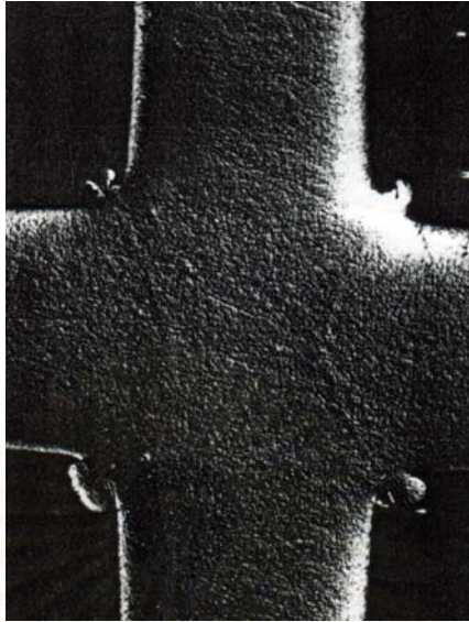
รูปที่ 22 จุดเชื่อมที่สมบูรณ์ ไม่มีรอยแยก ฟองอากาศหรือรูพรุน 56
