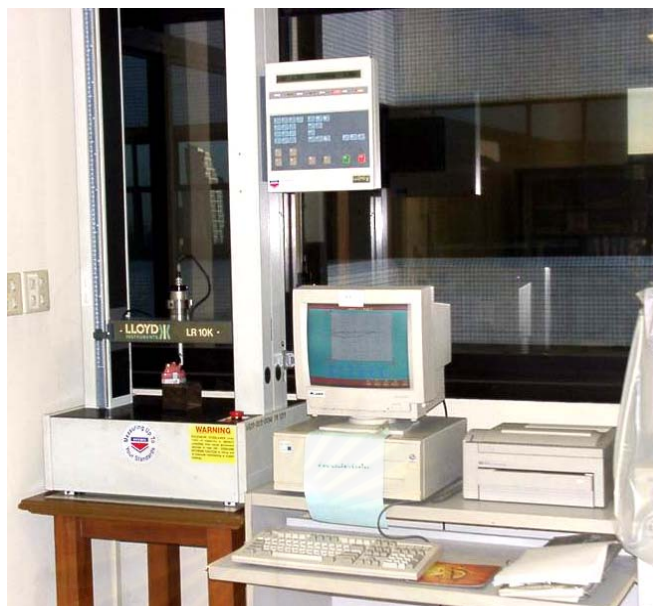
รูปที่ 24 ลอยด์ยูนิเวอร์แซลทดสอบดึงมาขึ้น
