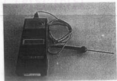
รูปที่ 3.4 เครื่องวัดอุณหภูมิ solomet 500e
