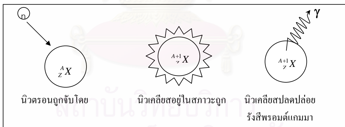
รูปที่ 2.1 แสดงการเกิดปฏิกิริยาการจับนิวตรอน และการเกิดรังสีพรอมต์แกมมา
