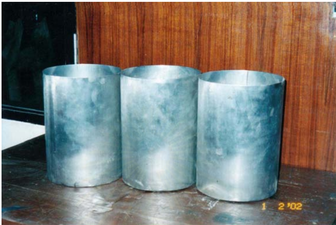
รูปที่ 3.2 ภาพสำหรับใส่ตัวอย่างทำด้วยเหล็กกล้าไร้สนิม
