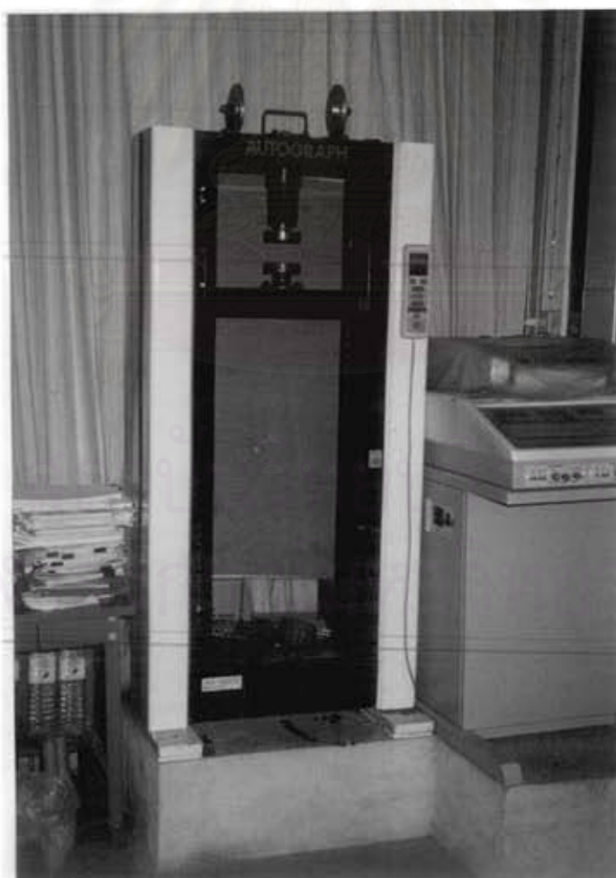
รูปที่ 4.4 เครื่องทดสอบกำลังรับแรงอัด Autograph วัดแรงอัดได้สูงสุด 1 ตัน
