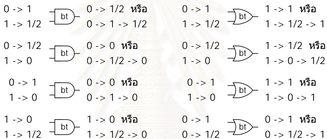
รูปที่ 3.3 พฤติกรรมการเปลี่ยนแปลงสัญญาณเอาต์พุต กรณีสัญญาณอินพุตอย่างน้อยหนึ่งอินพุต เปลี่ยนจากค่าข้อมูลค่าหนึ่งเป็นค่าข้อมูลอื่นแล้วเกิดฮาซาร์ด
