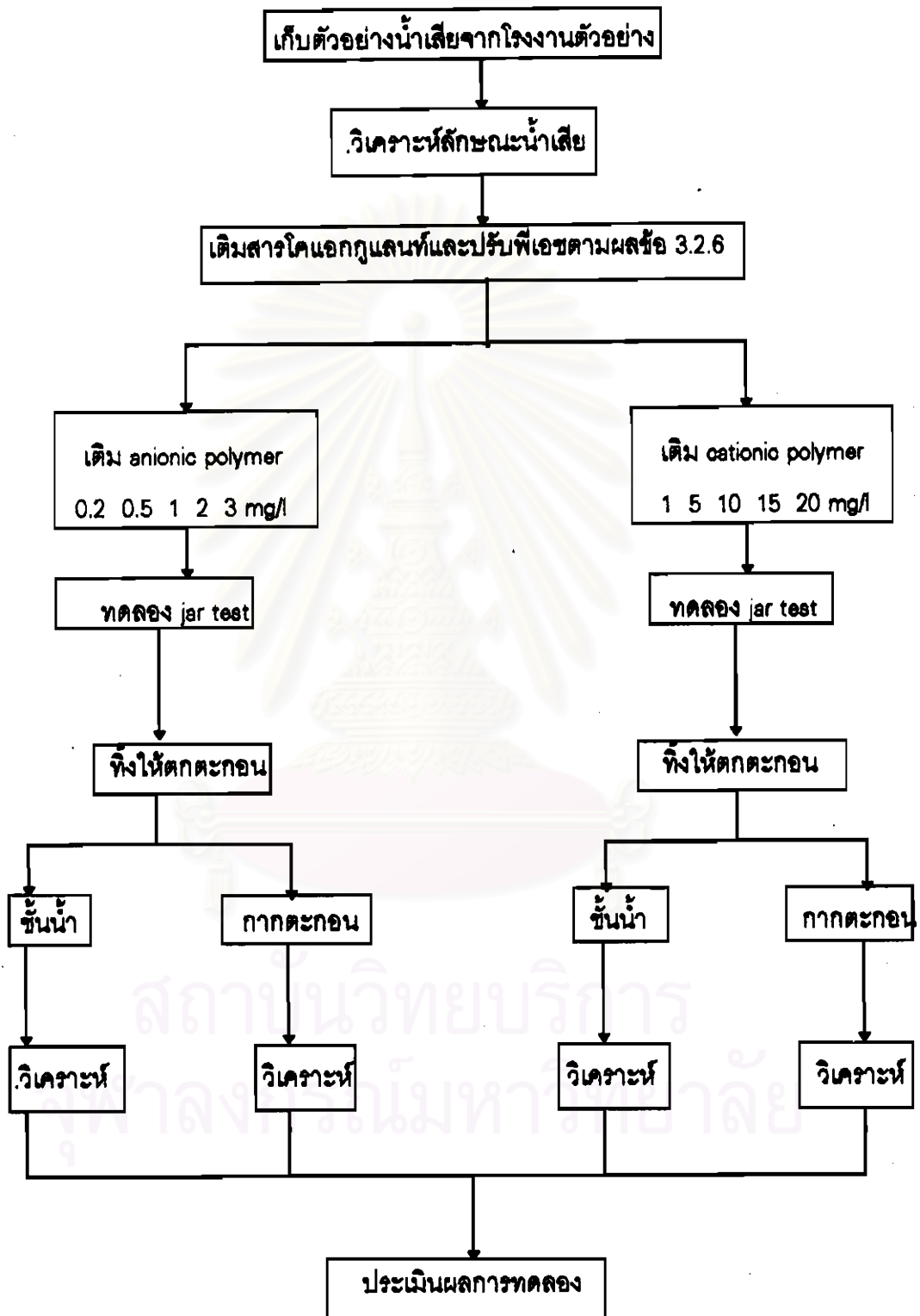
รูปที่ 3.7 แผนผังการทดลองกระบวนการตกตะกอน แบบใช้สารโคแอกกูแลนต์ร่วมกับสารโคแอกกูแลนต์เอ็ด
