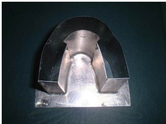
รูปที่ 13 แสดงแม่พิมพ์สเตนเลสสตีลหล่อแบบจำลองฟัน
